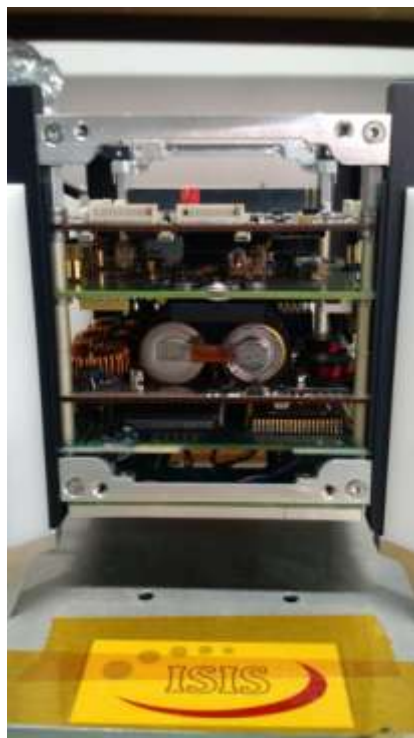
Figura 5 - PCBs de subsistemas.
